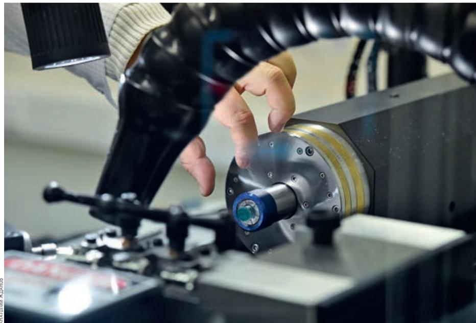
НА ТАКОМ СТАНКЕ ВЫТАЧИВАЮТ ОПТИЧЕСКИЕ МИКРОРЕЗОНАТОРЫ
