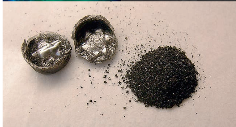
__Рис. 4. Графитоподобный углерод, полученный при разложении PET при давлении 2-3 ГПа и температурах 700 К
