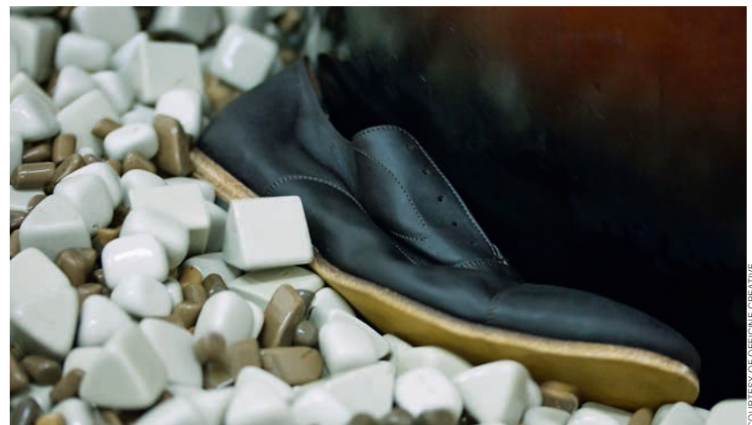
ТЕХНОЛОГИЯ STONE WASH — СТИРКА ГОТОВОЙ ОБУВИ С КАМНЯМИ
