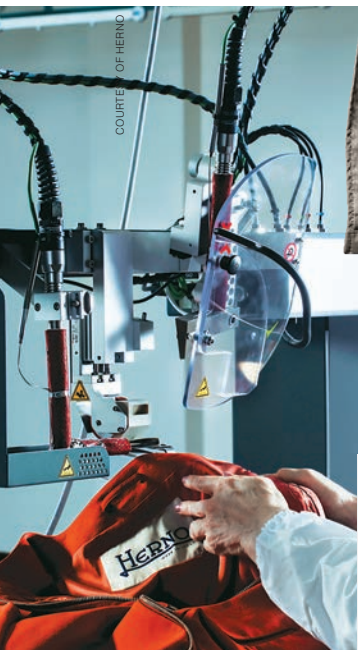
ПРОЦЕСС ТЕРМООБРАБОТКИ ШВОВ НА ПРОИЗВОДСТВЕ HERNO
