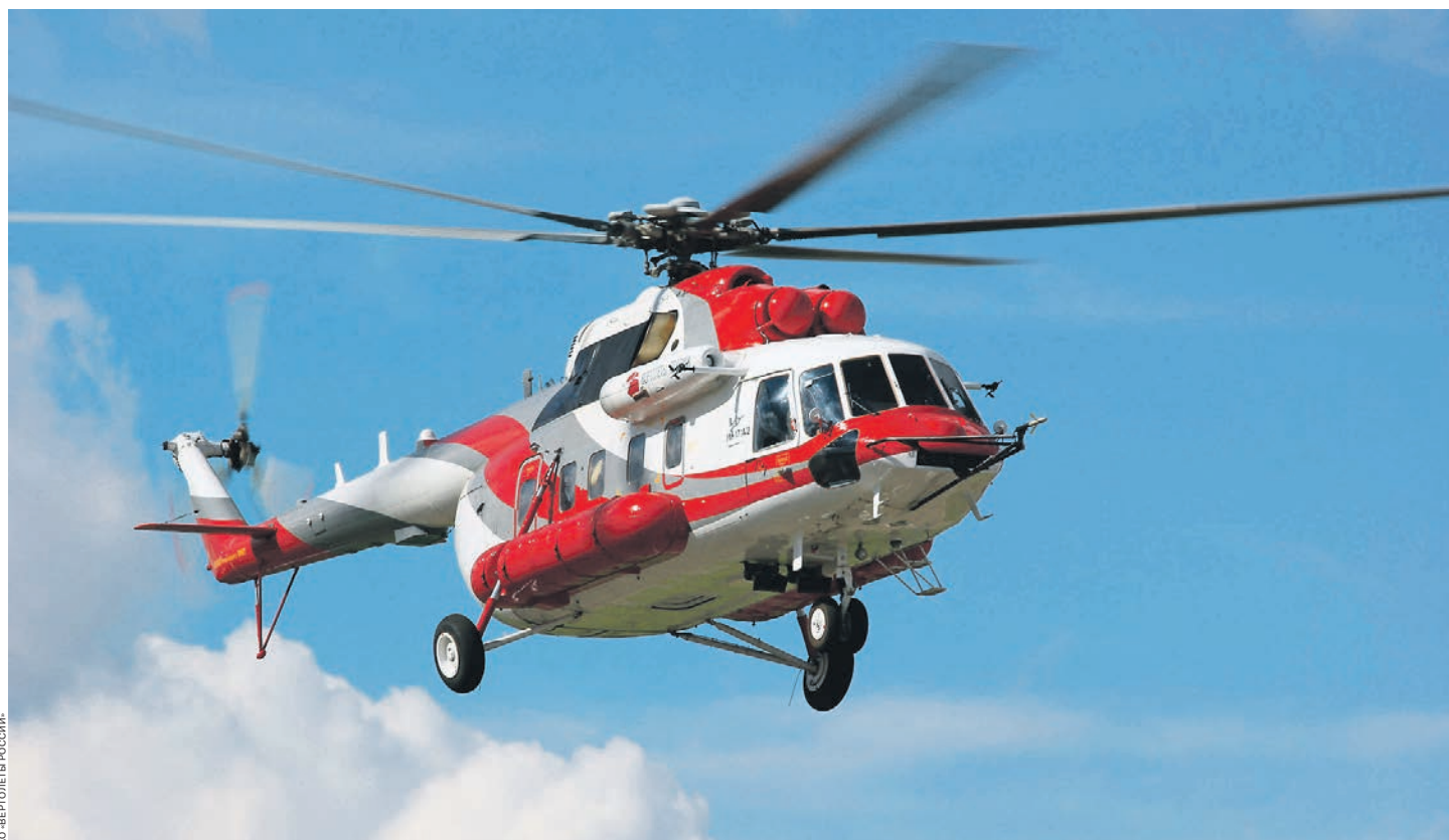
Модернизация бортового оборудования новой версии Ми-171А2 позволяет эффективно им управлять в экстремальных погодных и климатических условиях экипажем из двух человек
