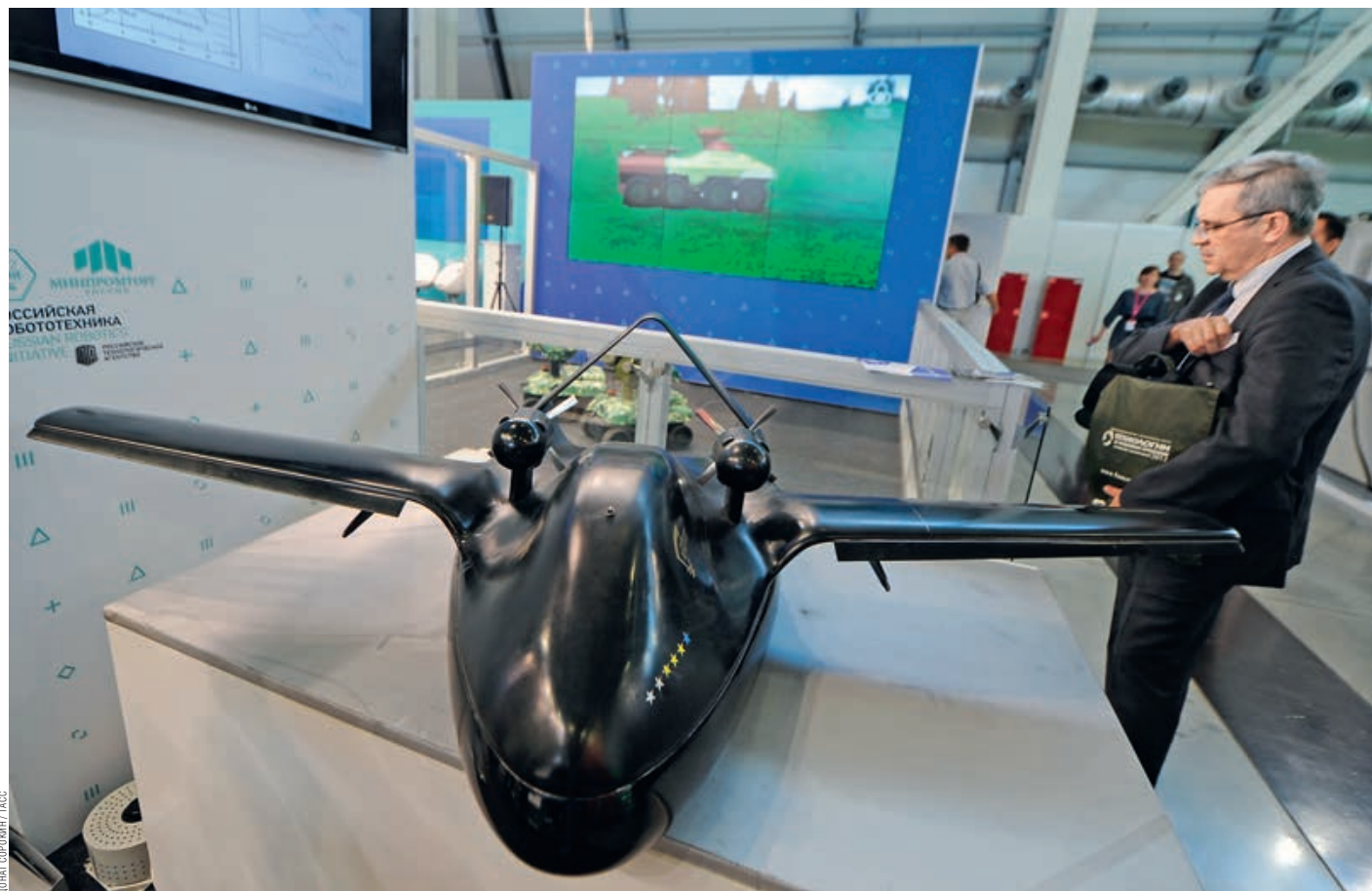
ДЕТАЛИ ДЛЯ ДРОНА «ЧИРОК» ПЕЧАТАЛИ НА 3D-ПРИНТЕРЕ
