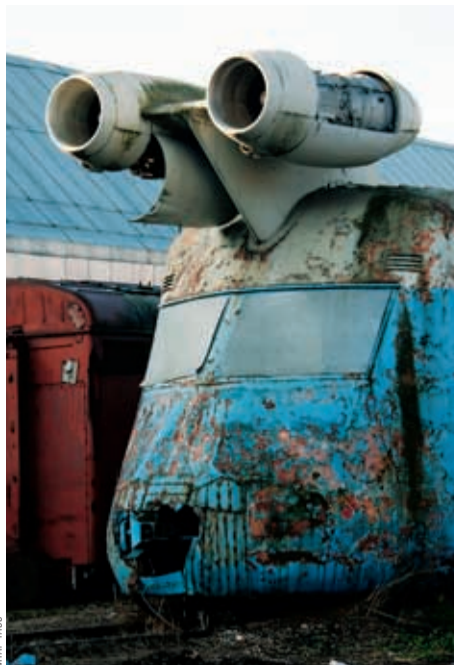
АМБИЦИОЗНЫЙ ПРОЕКТ ВАГОНА-ЛАБОРАТОРИИ С РЕАКТИВНОЙ ТЯГОЙ (1970) ОКАЗАЛСЯ НА ПРИКОЛЕ ИЗ-ЗА НЕДОСТАТКА ФИНАНСИРОВАНИЯ
