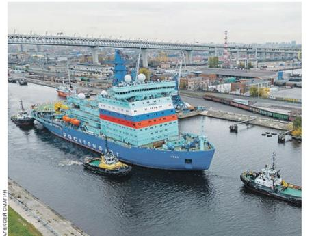
■ Поднят государственный флаг на втором серийном атомном ледоколе проекта 22220 «Урал», спущен на воду третий — «Якутия». Уникальная двухосадочная конструкция судна позволит ему эффективно работать на открытых морских участках и в устьях полярных рек. Новые суда позволят сделать навигацию по Северному морскому пути к концу 2024 года круглогодичной.
