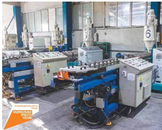
Пилотный участок производства гофротрубы в ООО «УралОмегаПласт»
