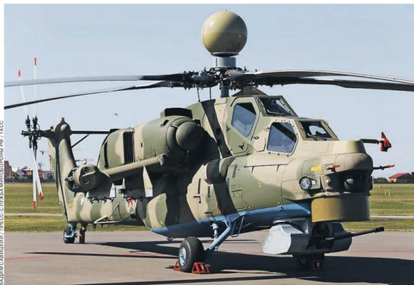
стью новой версии вертолета стали наддувочная радиолокационная станция Н025, модернизированные двигатели, обновленное бортовое радиоэлектронное оборудование, комплекс управляемого вооружения, а также возможность сопряжения с беспилотными авиаконструкциями. За эти и другие конструктивные новшества, которые сделали машину очень удобной и комфортной для использования, вертолетчики дали ему уважительное прозвище «Николай Михайлович».
