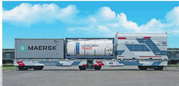
вестиций в модернизацию, для проезда тяжеловесных поездов и вагонов повышенной грузоподъемности. Однако совместно с Минтрансом и ОАО РЖД компания провела серию научных и натурных исследований, доказавших, что новая конструкция вагона не увеличивает, а даже уменьшает на 3% воздействие на путь по сравнению с обычным подвижным составом.
