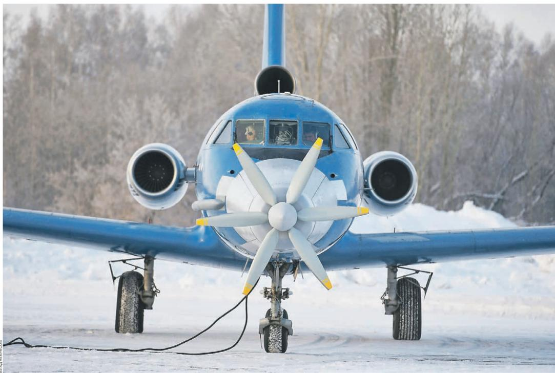
им. Н. Е. Жуковского») взял на себя разработку демонстратора гибридной силовой установки, включая электрогенератор на постоянных магнитах мощностью 400 кВт, созданный ЦИАМ в сотрудничестве с Уфимским государственным авиационным техническим университетом. А сам уникальный авиадвигатель разработан и построен российским научным стартапом Андрея Вавилова «СуперОкс», основной бизнес которого внедрение технологий с использованием материалов, обладающих свойствами электрической сверхпроводимости.
