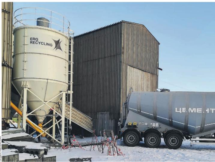
Актюбинский завод ферросплавов: из пыли газоочистки производятся брикеты и шлакоблоки
