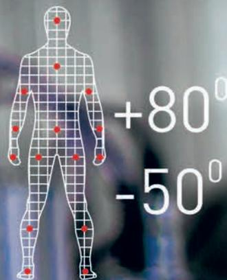
Единственный в России 24-зональный термоманекен "Newton", для испытания защитных свойств одежды и снаряжения в условиях экстремальных температур.
