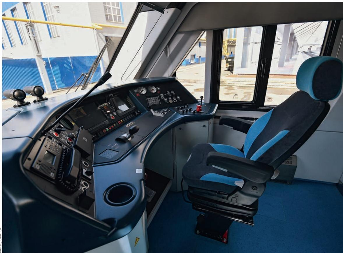
В КАБИНЕ МАШИНИСТА УСТАНОВЛЕНА ЦИФРОВАЯ СИСТЕМА УПРАВЛЕНИЯ ПОЕЗДОМ, БОЛЕЕ НАДЕЖНАЯ ПО СРАВНЕНИЮ С ИСПОЛЪЗУЕМОЙ В ЭЛЕКТРОПОЕЗДАХ РАНЬШЕ. ОНА ОБЕСПЕЧИВАЕТ ПОДДЕРЖКУ, СБОР И СОХРАНЕНИЕ ИНФОРМАЦИИ О РЕЖИМАХ ДВИЖЕНИЯ ЭЛЕКТРОПОЕЗДА, В ТОМ ЧИСЛЕ С УДАЛЕННЫМ ДОСТУПОМ, МОНИТОРИНГ ТЕХНИЧЕСКОГО СОСТОЯНИЯ СОСТАВА В РЕЖИМЕ РЕАЛЬНОГО ВРЕМЕНИ С ВОЗМОЖНОСТЬЮ ПЕРЕДАЧИ ИНФОРМАЦИИ ОНЛАЙН
