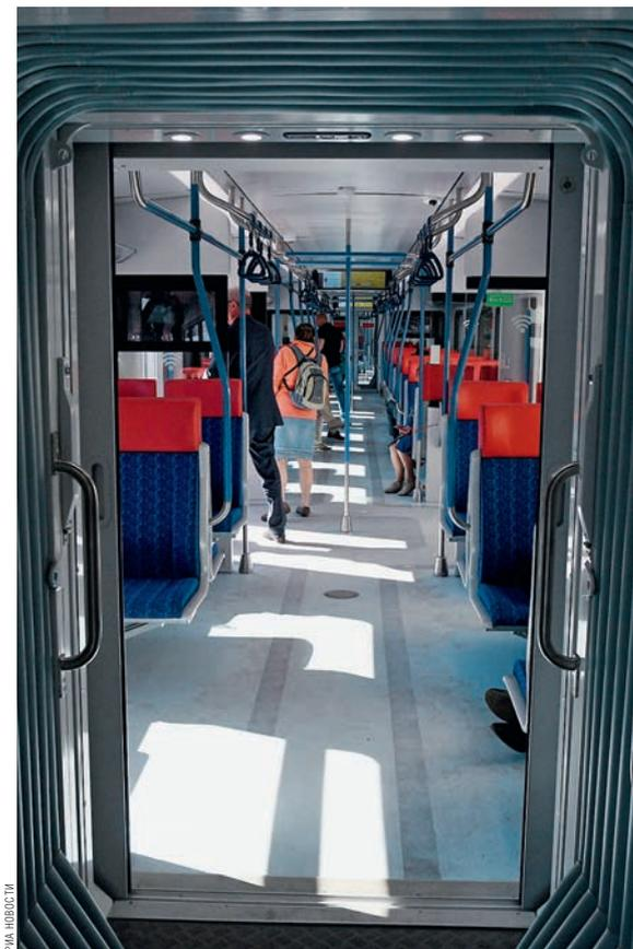
СКВОЗНОЙ ПРОХОД МЕЖДУ ВАГОНАМИ ОБЕСПЕЧИВАЕТ КОМФОРТНОЕ РАЗМЕЩЕНИЕ ПАССАЖИРОВ ДАЖЕ В ЧАСЫ ПИК
