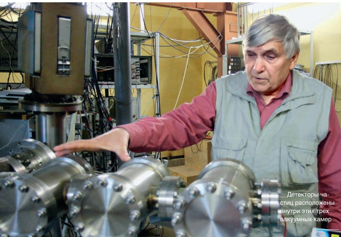
— Детекторы частиц расположены внутри этих трех вакуумных камер
