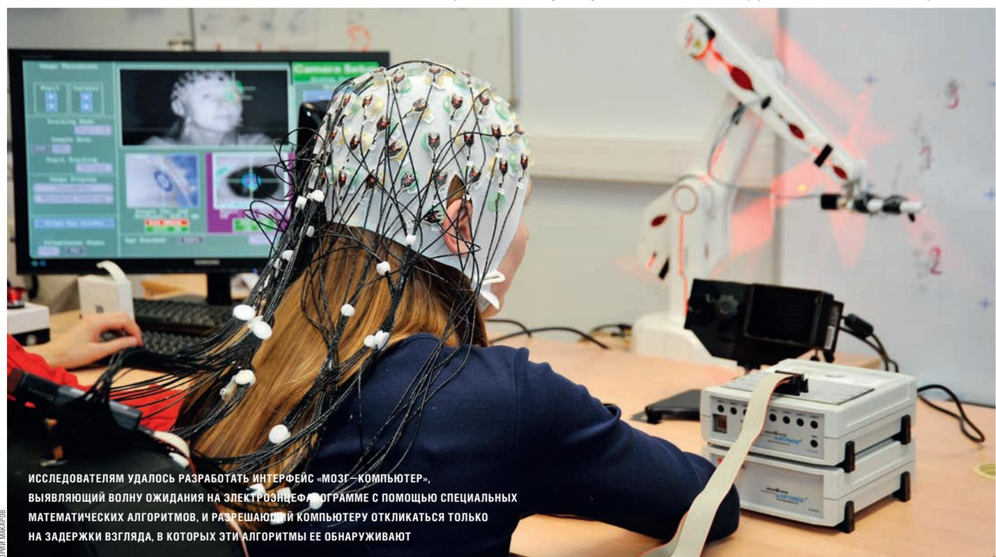
ИССЛЕДОВАТЕЛЯМ УДАЛОСЬ РАЗРАБОТАТЬ ИНТЕРФЕЙС «МОЗГ—КОМПЬЮТЕР», ВЫЯВЛЯЮЩИЙ ВОЛНУ ОЖИДАНИЯ НА ЭЛЕКТРОЭНЦЕФАЛОГРАММЕ С ПОМОЩЬЮ СПЕЦИАЛЬНЫХ МАТЕМАТИЧЕСКИХ АЛГОРИТМОВ, И РАЗРЕШАЮЩИЙ КОМПЬЮТЕРУ ОТКЛИКАТЬСЯ ТОЛЬКО НА ЗАДЕРЖКИ ВЗГЛЯДА, В КОТОРЫХ ЭТИ АЛГОРИТМЫ ЕЕ ОБНАРУЖИВАЮТ
