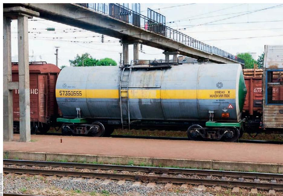
НОВЫЙ ТИП ПОДВИЖНОГО СОСТАВА — ЦИСТЕРНЫ ИЗ АЛЮМИНИЕВОГО СПЛАВА
