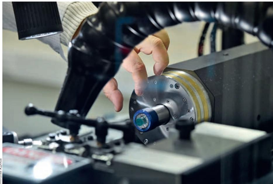
НА ТАКОМ СТАНКЕ ВЫТАЧИВАЮТ ОПТИЧЕСКИЕ МИКРОРЕЗОНАТОРЫ
