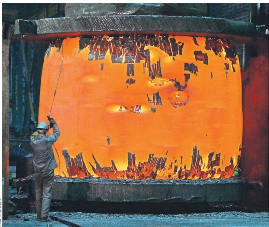
Именно компетенции в атомной энергетике позволили «Ижорским заводам» уверенно себя чувствовать и на рынке нефтегазопереработки. Ковка опытной обечайки активной зоны реактора по проекту ВВЭР-ТОИ
