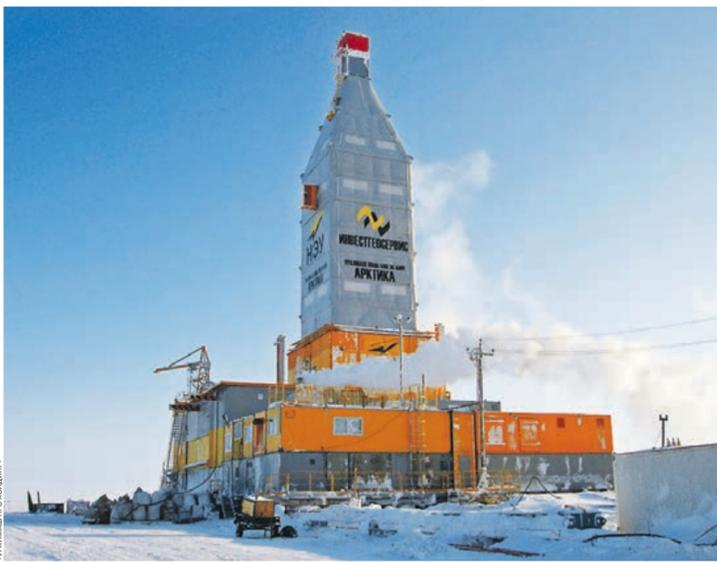
Выпуск в серию буровой установки БУ 6000/400 ЭК-БМЧ «Арктика», способной работать в условиях полярной зимы, — это пример успешного импортозамещения, поскольку установка пока не имеет аналогов в мире
