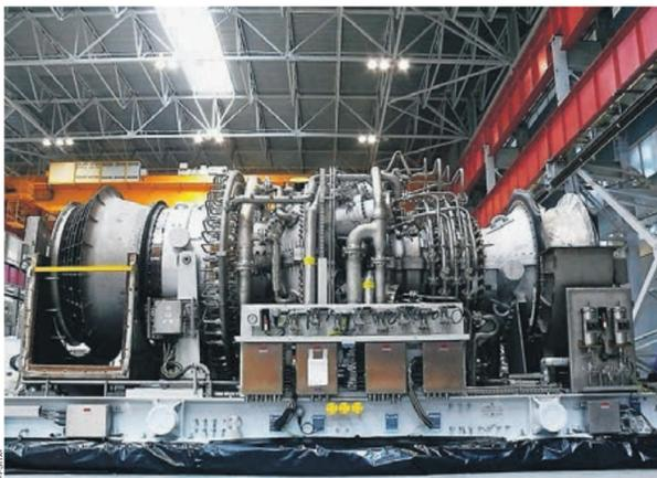
Турбина MS5002E мощностью 32 МВт производства ЗАО «РЭП Холдинг» — это вершина инженерного искусства и грамотной политики импортозамещения
