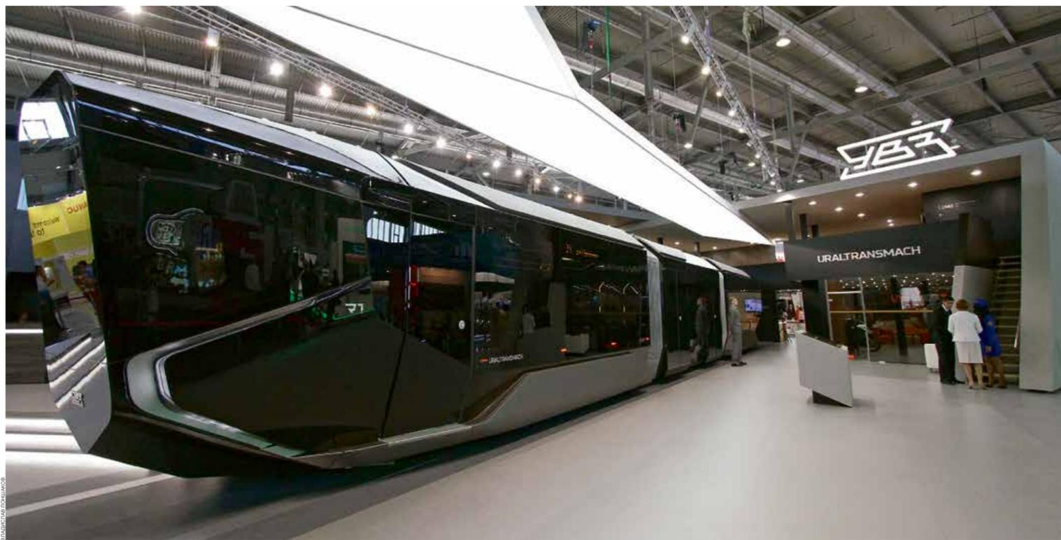
городу — 24 км/ч. Кабину водителя оборудуют лобовым стеклом с обратным углом наклона, что позволит расширить обзорность, снизить количество бликов и избежать чрезмерного нагрева кабины солнечным светом. При этом УВЗ планирует установить для каждого города, где будет курсировать R1, свою уникальную кабину. Это возможно благодаря тому, что кузов имеет модульную конструкцию.
