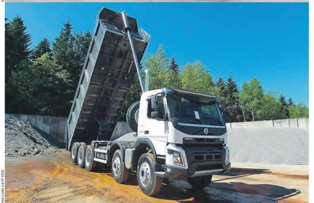
Новое поколение Volvo FMX: усиленная рама, трехсекционный металлический бампер, мощная защита узлов и агрегатов, усиленные буксирные проушины и «внедорожный» угол въезда — 25°
