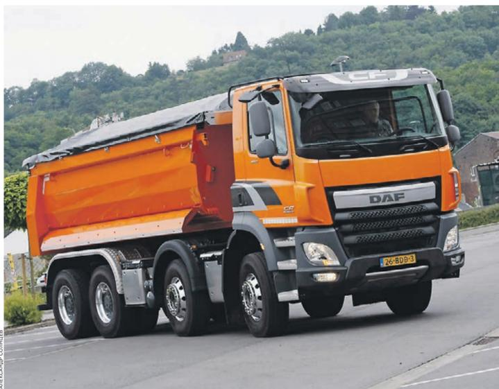
Тяжелый самосвал DAF CF с двумя ведущими задними мостами
