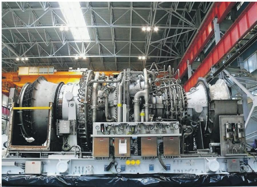
Турбина MS5002E мощностью 32 МВт производства РЭПХа — одно из самых сложных технических устройств в энергетическом машиностроении
