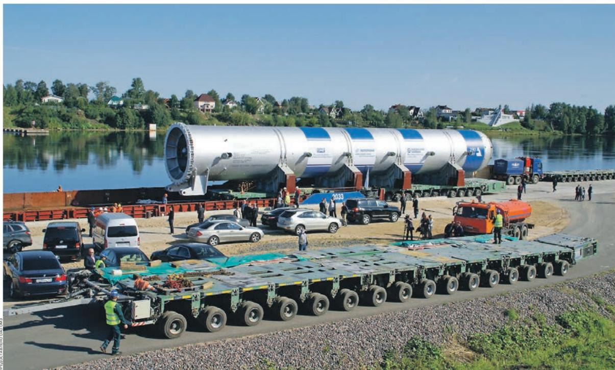
До «Ижорских заводов» никто в стране не перевозил таких гигантских грузов на такие расстояния. Например, вес автопоезда с оборудованием составил 1,5 тыс. тонн. А в поселке Усть-Славянка теперь функционирует даже специально построенный грузовой причал на Неве
