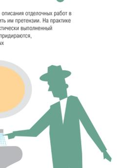
ток свежего воздуха, и поднесите пламя к вентиляционной решетке. Если вентиляция исправна, огонек наклонится в сторону решетки практически горизонтально. Слабый наклон пламени, равно как его отсутствие, не говоря уже об обратной тяге, говорят о серьезных строительных нарушениях.
