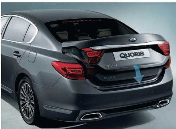
КРЫШКА БАГАЖНИКА ОСНАЩЕНА ЭЛЕКТРОПРИВОДОМ И СЕНСОРОМ ПОМЕХ
