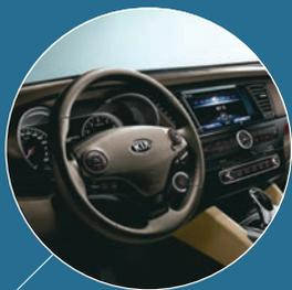
С ЭЛЕКТРОГИДРАВЛИЧЕСКИМ УСИЛИТЕЛЕМ ENPS С ПЕРЕМЕННОЙ ПРОИЗВОДИТЕЛЬНОСТЬЮ ТРЕБУЕТСЯ ЛИШЬ 2,98 ОБОРОТА, А В ВЕРСИИ С ПНЕВМАТИЧЕСКОЙ ПОДВЕСКОЙ ВСЕГО 2,81 ОБОРОТА РУЛЯ ОТ УПОРА ДО УПОРА
