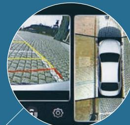
СИСТЕМА КРУГОВОГО ОБЗОРА С ЧЕТЫРЬМЯ КАМЕРАМИ, РАСПОЛОЖЕННЫМИ СПЕРЕДИ, СЗАДИ И ПО БОКАМ, ОБЕСПЕЧИВАЕТ КРУГОВОЙ ОБЗОР С ОХВАТОМ 360 ГРАДУСОВ И ПОКАЗЫВАЮТ ВИРТУАЛЬНЫЙ «ВИД СВЕРХУ»
