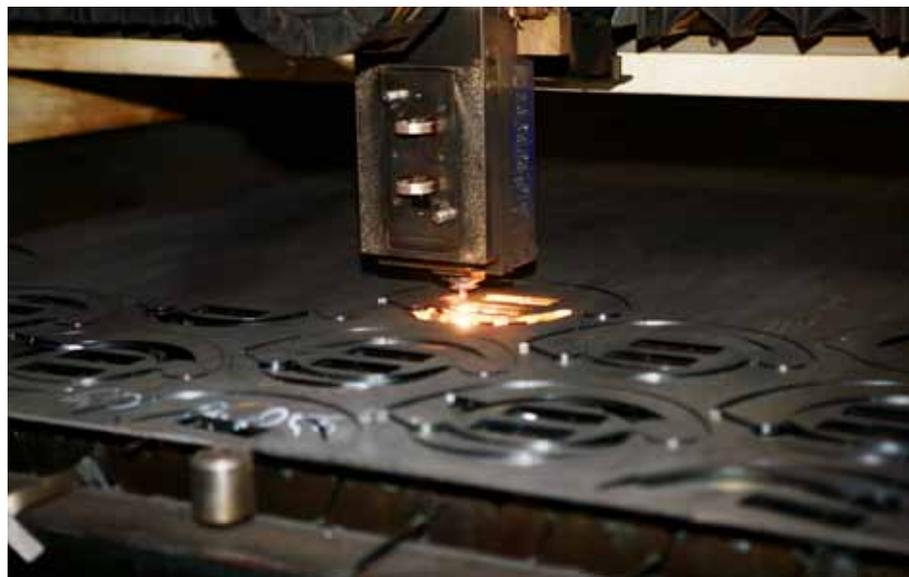
исключено появление заусенцев и наплывов на металле. Лазерная резка дополняется технологиями высокоточной гибки, вальцовки, а также недавно появившейся на нашем предприятии роботизированной сварки. Такая производственная база позволяет изготавливать корпуса, панели, детали и оборудование любой сложности, самых нестандартных размеров и форм.
