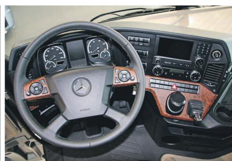
Мультифункциональный руль регулируется в двух плоскостях в довольно большом диапазоне
