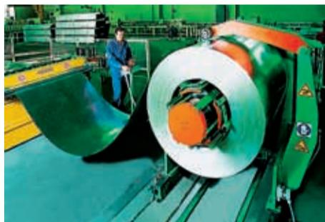
ИЗ ОЦИНКОВАННОЙ СТАЛЬНОЙ ЛЕНТЫ (НА ФОТО) СДЕЛАЮТ МЕТАЛЛИЧЕСКИЕ ПРОФИЛИ, КОТОРЫЕ ЗАТЕМ ИСПОЛЬЗУЮТ ПРИ СТРОИТЕЛЬСТВЕ ЛЮБЫХ ОБЪЕКТОВ НЕДВИЖИМОСТИ — ОТ ЧАСТНЫХ ДОМОВ ДО АЭРОПОРТОВ
