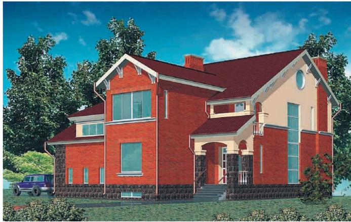
Принцип застройки: фундамент — монолит, стены — кирпич, крыша — керамическая черепица
