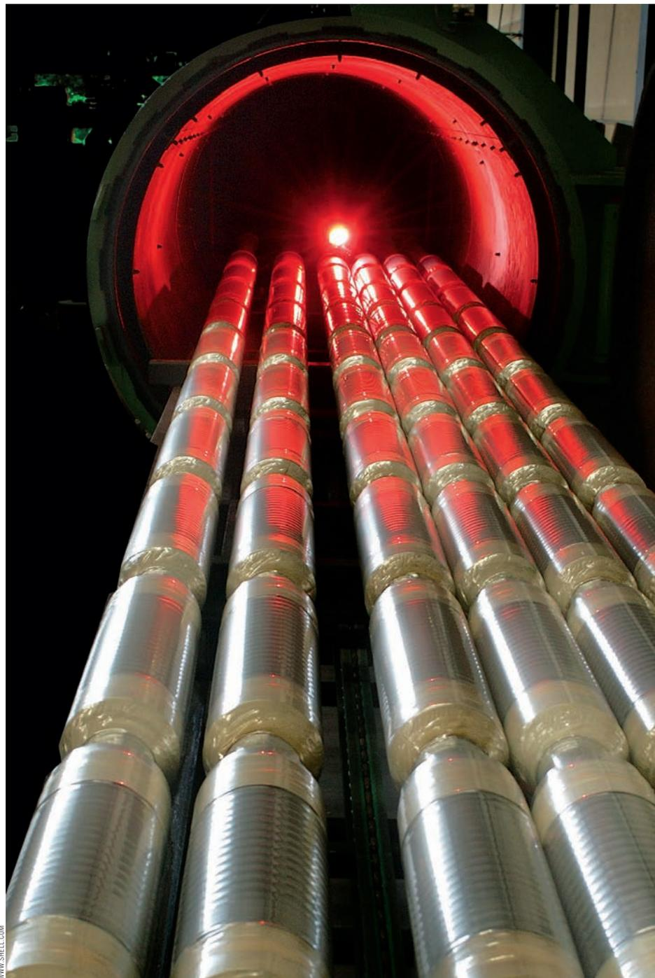
**ОБЕРТЫВАНИЕ СКВАЖИНЫХ ТРУБ НАБУХАЮЩИМ СЛОЕМ РЕЗИНЫ (ТЕХНОЛОГИЯ EZIP), КОТОРЫЙ ВПИТЫВАЕТ ПРОСАЧИВАЮЩУЮСЯ ВОДУ, ПОЗВОЛЯЕТ ПОЛНОСТЬЮ ИЗОЛИРОВАТЬ ЕЕ ОТ НЕФТИ**
