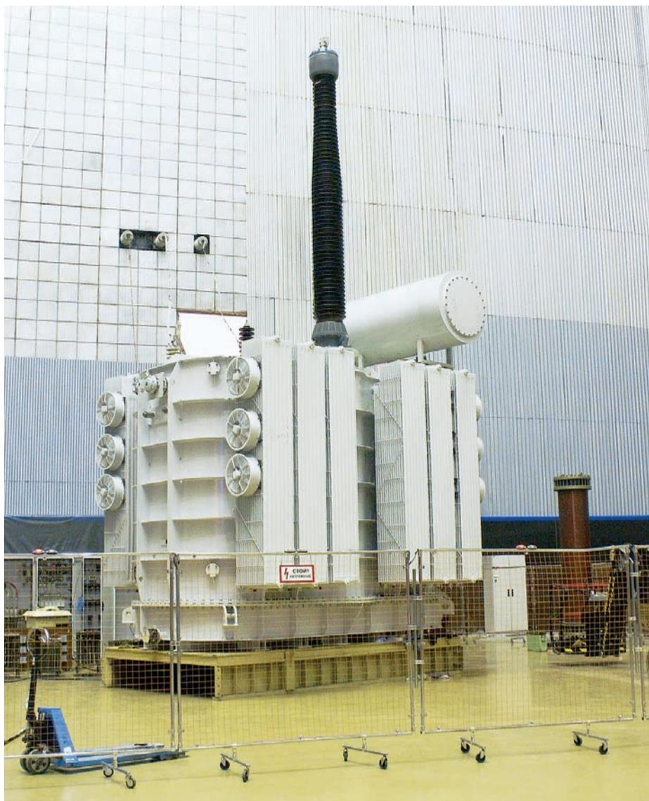
УПРАВЛЯЕМЫЙ ШУНТИРУЮЩИЙ РЕАКТОР ДЛЯ ПОДСТАНЦИИ 500 КВ НЕЛЫМ В ИСПЫТАТЕЛЬНОМ ЗАЛЕ ОАО «ЭЛЕКТРОЗАВОД»
