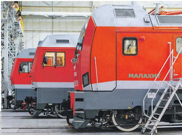
ЗТЭ25К2М, который комплектовался американским дизельным двигателем. Новый локомотив ЗТЭ28 укомплектован уже российскими дизель-генераторами 18–9ДГМ, которые выпускает предприятие ТМХ — Коломенский завод. Имея три секции, ЗТЭ28 включает, соответственно, три дизель-генератора. Они обеспечивают мощность 9,3 тыс. кВт для вождения поездов 7,1 тыс. тонн в условиях Восточного полигона. Локомотив уже прошел опытный пробег, а РЖД ожидает поставки в 2023 году 30 таких тепловозов.
