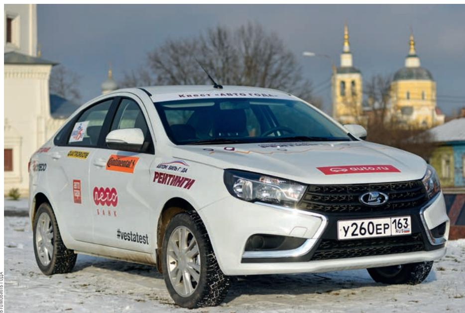
В О ВСЕХ КОМПЛЕКТАЦИЯХ VESTA ЕСТЬ НЕ ТОЛЬКО ПРИВЫЧНЫЕ УЖЕ ABS И РЕГУЛЯТОР РАСПРЕДЕЛЕНИЯ ТОРМОЗНЫХ СИЛ EBD, НО И СИСТЕМА КУРСОВОЙ УСТОЙЧИВОСТИ ESC И АССИСТЕНТ ТРОГАНИЯ НА ПОДЪЕМЕ И СПУСКЕ, КОТОРЫЙ УДЕРЖИВАЕТ АВТОМОБИЛЬ НА МЕСТЕ В ТЕЧЕНИЕ ДВУХ СЕКУНД ПОСЛЕ ОТПУСКАНИЯ ТОРМОЗА
