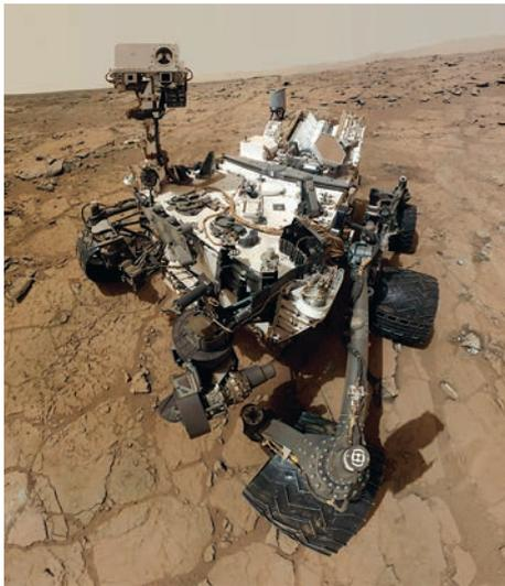
РАДИОИЗОТОПНЫЕ ГЕНЕРАТОРЫ ОБЕСПЕЧИВАЮТ ЭНЕРГИЕЙ МАРСОХОД CURIOSITY
