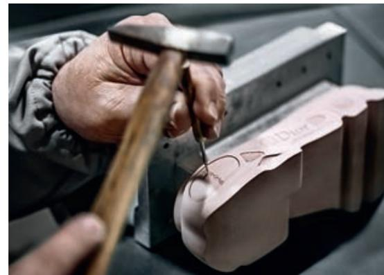
ПРОЦЕСС СОЗДАНИЯ ПРОТОТИПА ПОДОШВЫ
