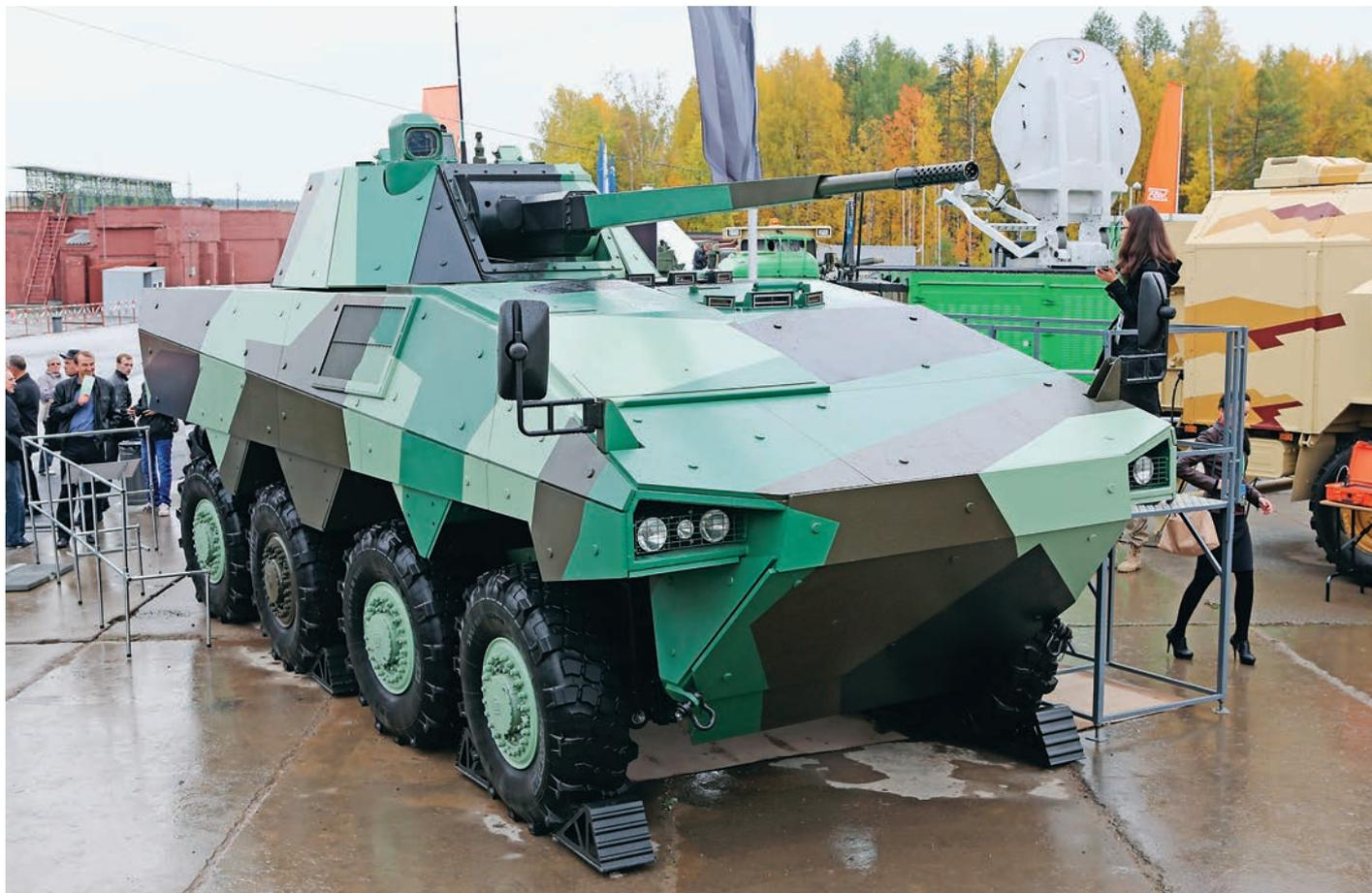
«АТОМ» СПОСОБЕН РАЗВИВАТЬ МАКСИМАЛЬНУЮ СКОРОСТЬ ПО ШОССЕ ДО 100 КИЛОМЕТРОВ В ЧАС С ЗАПАСОМ ХОДА ДО 750 КИЛОМЕТРОВ
