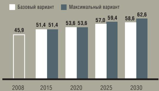
ДИНАМИКА РАЗВИТИЯ ТЭС (С УЧЕТОМ РЕКОНСТРУКЦИИ; УСТАНОВЛЕННАЯ МОЩНОСТЬ, ГВТ) ИСТОЧНИК: МИПРОМТОРГ.
