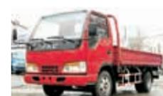
**JAC HFC1040K** — самый доступный грузовик в линейке компании. Он предназначен для транспортировки грузов массой до 2,5 т. Комплектуется двигателями объемом 2,7 л либо 3,7 л мощностью соответственно 77 л. с. и 81 л. с. Цена — \$13,9 тыс.
